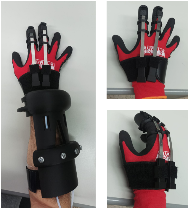
Figura 1: Detalle del guante Exoglove y vista general del prototipo. A la izquierda, vista superior del prototipo funcional Exoglove vestido. A la derecha, vistas superiores del detalle del guante mostrando la distribución de tendones (arriba) y el sistema en estado de actuación activa (abajo).
