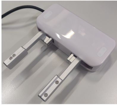
Figura 3: Pinza UF BIO gripper con control de fuerza.
