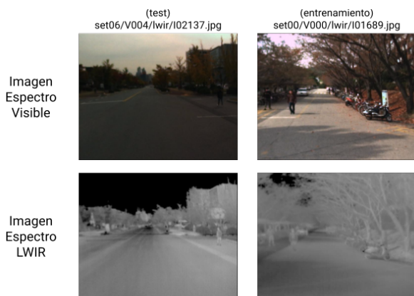
Figura 2: Ejemplos de pares de imágenes visible-LWIR del dataset KAIST en condición diurna.
