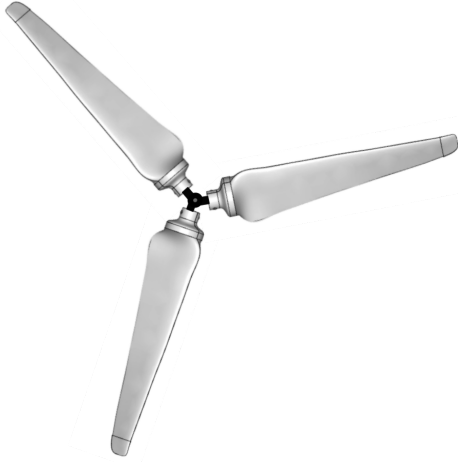
Figura 2: Ensamble de las palas del prototipo sujetas al mecanismo de rotación.
