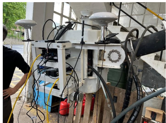
Figura 2: Detalle del cabezal de la grúa donde se observan los sensores GPS y láser
