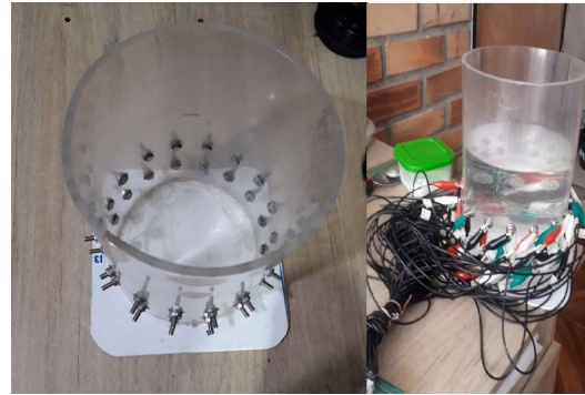
Figura 2: Tanque de pruebas para el sistema TIE.
